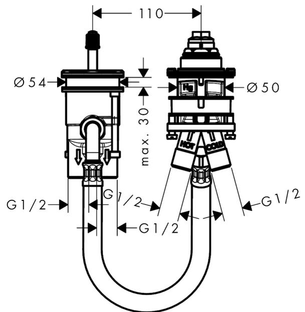
**Corps d'encastrement pour mitigeur 2 trous sur bord de baignoire**
