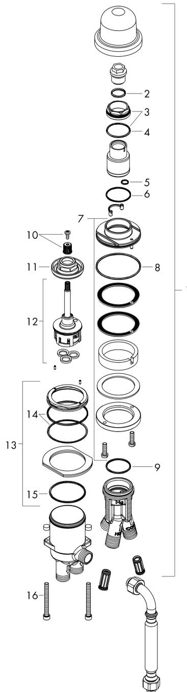
**Corps d'encastrement pour mitigeur 2 trous sur bord de baignoire**Finition: Numéro d'article: **13159180**
