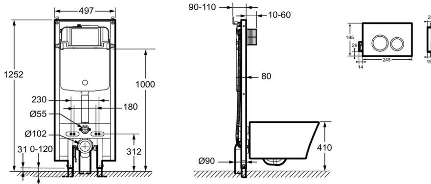
Descriptif CCTP : Pack bâti pour WC lavant avec alimentation en eau et électrique. E28935. Collection : SEINE. DIMENSIONS : 120 x 49,70 cm. MATÉRIAU : N/A. TYPE D'INSTALLATION : Mural. FIXATION DU RÉSERVOIR : Encastré. GARANTIE DU BÂTI SUPPORT : 2 ans. GARANTIE DE LA PLAQUE DE COMMANDE : 2 ans. CONSOMMATION D'EAU : Standard 3/6 L. FIXATIONS DU BÂTI SUPPORT : Murales.
