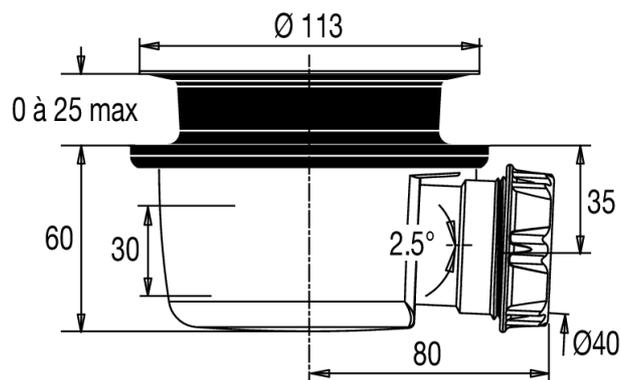
Descriptif CCTP : Bonde extra-plate NF sans capot. E78172. Collection : Hors collection. DIMENSIONS : 14 x 9 x 6 cm. MATÉRIAU : Plastique. NORMES ET RÉGLEMENTATIONS : NF. ANTIDÉRAPANT : Non. DIAMÈTRE DE BONDE (CM) : 9. Débit 29 L/min mesuré selon la norme NF. Garde d'eau de 30 mm pour éviter les remontées d'odeurs. Bonde standard diamètre 90 mm compatible avec tous les receveurs livrés avec capot et notamment Singulier et Flight Neus.
