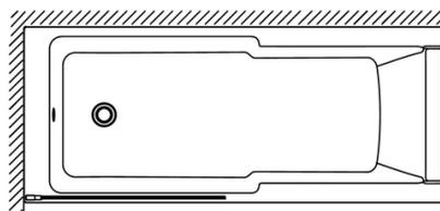
Descriptif CCTP : Pare-bain, 1 volet. E6D042. Collection : STRUKTURA. DIMENSIONS : 1,50 x 80 x 140 cm. POIDS : 19,5 kg. MATÉRIAU : Verre. NORMES ET RÉGLEMENTATIONS : EN 14428. CONSEILS D'ENTRETIEN : à nettoyer à l'eau savonneuse. DURÉE GARANTIE (ANNÉES) : 2. COMPATIBILITÉ : Avec toutes les baignoires rectangulaires.
