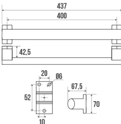
Tube elliptique en aluminium anodisé brillant 38 x 25 mm. Cache-fixations en résine de synthèse chromés.
