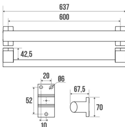
Tube elliptique en aluminium anodisé brillant, 38 x 25 mm. Cache-fixations en résine de synthèse chromés.
