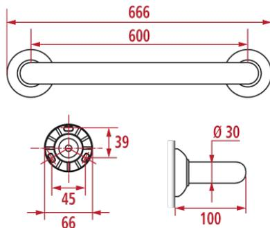
Tube aluminium blanc Ø 30 mm, cache-fixations blanc en résine de synthèse, Ø 65 mm.
