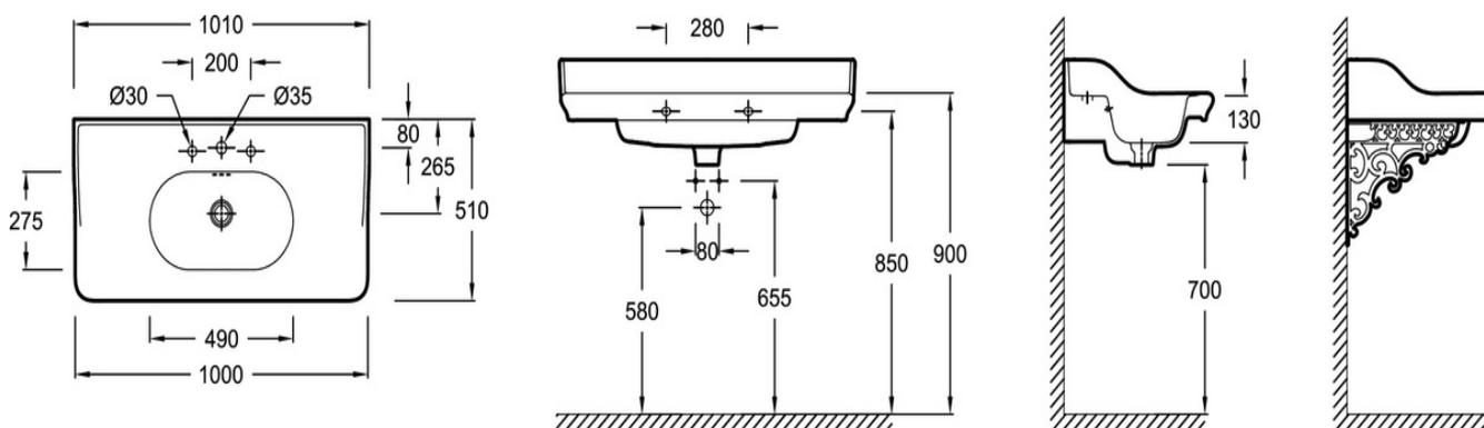
Descriptif CCTP : Plan-vasque 101 cm, 3 trous. EXW112-53. Collection : CLÉO 1889. DIMENSIONS : 101 x 51 cm. POIDS : 35 kg. MATÉRIAU : Céramique. TYPED'INSTALLATION : Posé. CONFIGURATION : Standard. HAUTEUR CONFORT : 13 cm. FIXATIONS : 2 goujons. PERCEMENT ROBINETTERIE : 3 trous. MEULÉ/NON-MEULÉ : Non meulé. TROP-PLEIN : Avec trou de trop-plein. NOMBRE DE VASQUES : 1 cuve. LIVRÉ AVEC : Bonde céramique. ROBINETTERIE CONSEILLÉE : Cléo 1889. INFORMATIONS COMPLÉMENTAIRES : Robinetterie non incluse.
