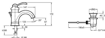
Descriptif CCTP : Mitigeur lavabo avec flexibles d'alimentation. E72090. Collection : FAIRFAX. DIMENSIONS : 17,20 cm. POIDS : 2,1 kg. MATÉRIAU : Métal. TYPE D'INSTALLATION : 1 trou. TYPE : Mitigeur. DÉBIT (L/MN SOUS 3 BAR) : 12 l/mn. SAILLIE DU BEC (MM) : 133. RACCORDS : Avec flexibles d'alimentation. MÉCANISME : Cartouche à disques céramique. Le charme rétro associé à la modernité d'un mitigeur. Aérateur anti-calcaire intégré.
