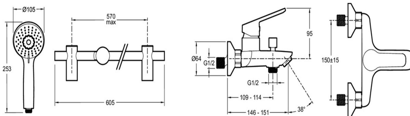
Descriptif CCTP : Set bain-douche avec mitigeur. E24429. Collection : AIMÉ. MATÉRIAU : Métal. TYPE D'INSTALLATION : Mural. RACCORDS : Avec raccords et rosaces murales. TYPE : Mitigeur. DÉBIT SORTIE BAIN : 22 l/mn. AVEC OU SANS ROBINETTERIE : Avec. DÉBIT DOUCHETTE : 10 l/mn. TYPE DE FLEXIBLE : anti-torsion. NOMBRE DE JETS : 3.
