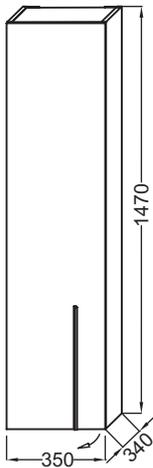
Descriptif CCTP : Colonne 35 cm, gauche. EB3047G. Collection : NOUVELLE VAGUE. DIMENSIONS : 35 x 34 x 147 cm. POIDS : 23,6 kg. MATÉRIAU : Laque et mélaminé. TYPE D'INSTALLATION : Mural. TYPE DE RANGEMENT : Porte. PRISE ÉLECTRIQUE : 2. PRISE USB : 2. ETAGÈRE : Oui. VERSION : Gauche. FINITION INTÉRIEURE : Basalte. RANGEMENT INTÉRIEUR : 3 étagères. FIXATION : Set de fixation à déterminer par votre installateur en fonction de votre support mural.
