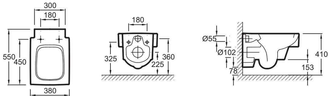
Descriptif CCTP : Cuvette suspendue. EDA102. Collection : TERRACE. POIDS : 25,3 kg. MATÉRIAU : Céramique. TYPE D'INSTALLATION : Suspendu. CONSOMMATION D'EAU : 2,6/4 L et 3/6 L. HAUTEUR : Réglable de 38 à 50 cm. TYPE DE BRIDE : Ouverte (traditionnelle). MÉCANISME DE CHASSE : Double chasse.
