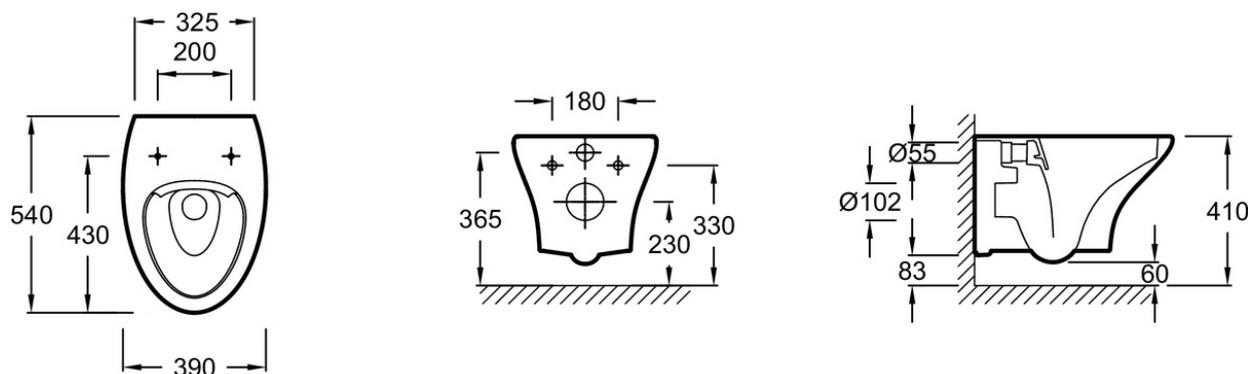
Descriptif CCTP : Cuvette suspendue SANS BRIDE. EDJ102. Collection : NOUVELLE VAGUE. DIMENSIONS : 54 x 39 cm. POIDS : 20 kg. MATÉRIAU : Céramique. TYPE D'INSTALLATION : Suspendu. FORME : Arrondie. MÉCANISME DE CHASSE : Double chasse. CONSOMMATION D'EAU : 2,6/4 L et 3/6 L. HAUTEUR : Standard. TYPE DE BRIDE : Sans bride. GARANTIE DE LA CÉRAMIQUE : 10 ans. FIXATION DE LA CUVETTE : Invisibles.
