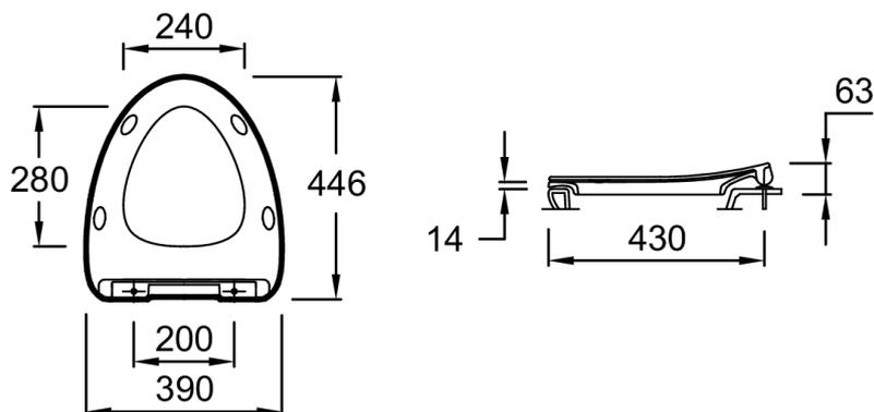
Descriptif CCTP : Abattant thermodur extra-plat à descente progressive. E20069. Collection : NOUVELLE VAGUE. POIDS : 2,9 kg. MATÉRIAU : Thermodur. TYPE D'ABATTANT : Extra-plat. ABATTANT : déclipable à descente progressive. CHARNIÈRES : Métal. ABATTANT ANTIBACTÉRIEN : Non. GARANTIE DE L'ABATTANT : 2 ans. CONDITIONNEMENT : 1 colis.
