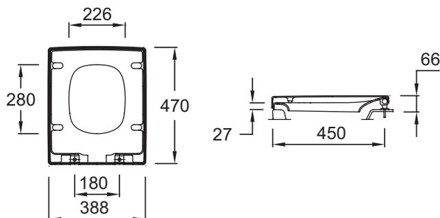
Descriptif CCTP : Abattant thermodur à descente progressive. E70019. Collection : TERRACE. POIDS : 3,4 kg. MATÉRIAU : Thermodur. TYPE D'ABATTANT : Standard. ABATTANT : A descente progressive. CHARNIÈRES : métal.
