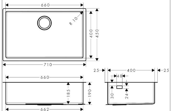
**D14-11 Garniture de vidage automatique pour simple cuve**Surfaces: **acier inoxydable** Numéro d'article: **43931800**
