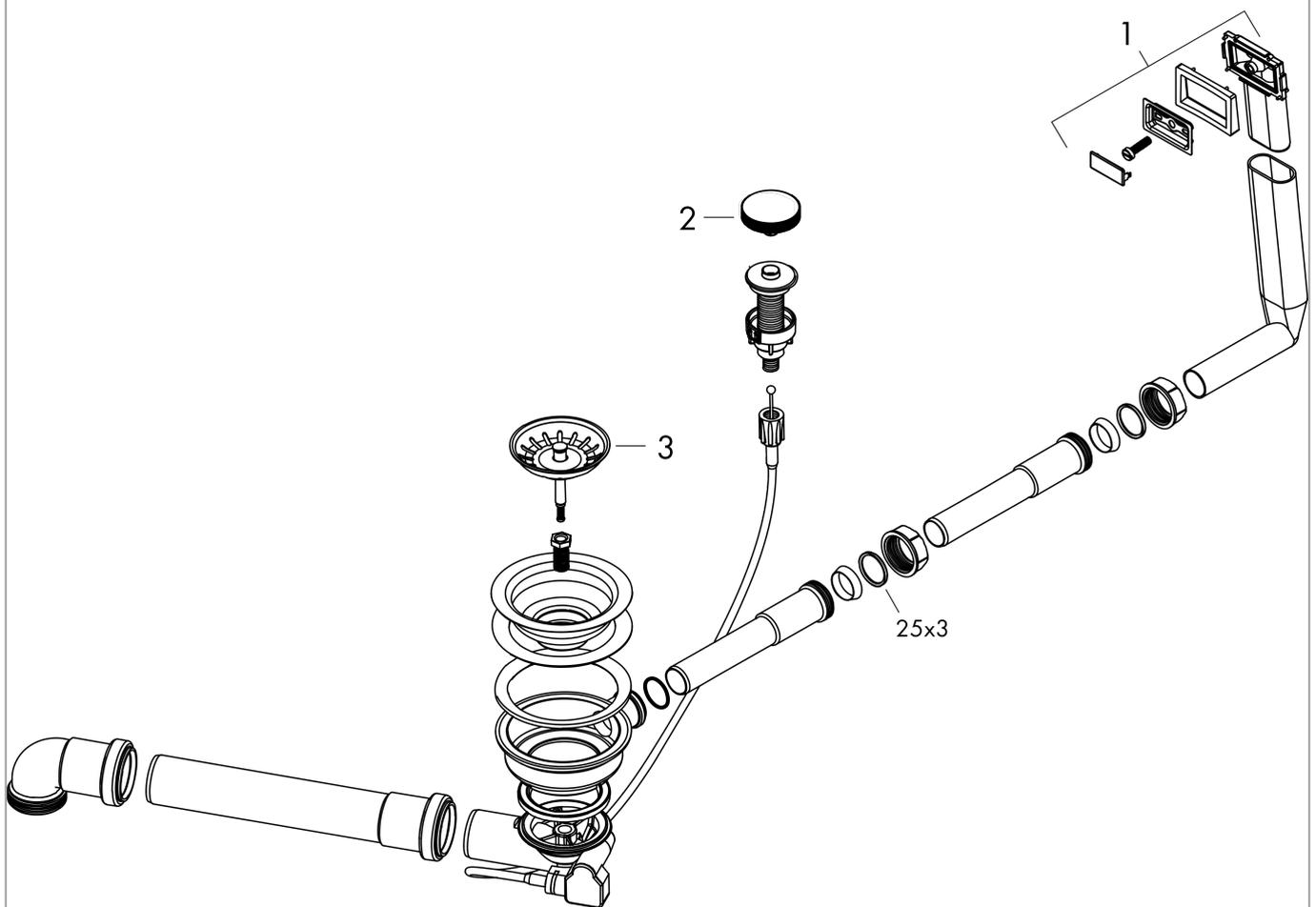
**D14-11 Garniture de vidage automatique pour simple cuve**Surfaces: **acier inoxydable** Numéro d'article: **43931800**
