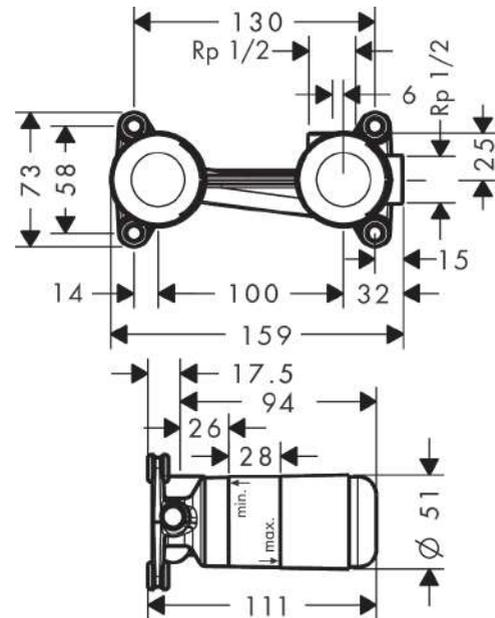
**Corps d'encastrement pour mitigeur de lavabo encastré au mur**
