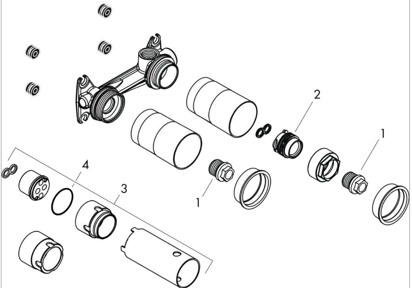
**Corps d'encastrement pour mitigeur de lavabo encastré au mur**Surfaces: p.a. Numéro d'article: **13622180**
