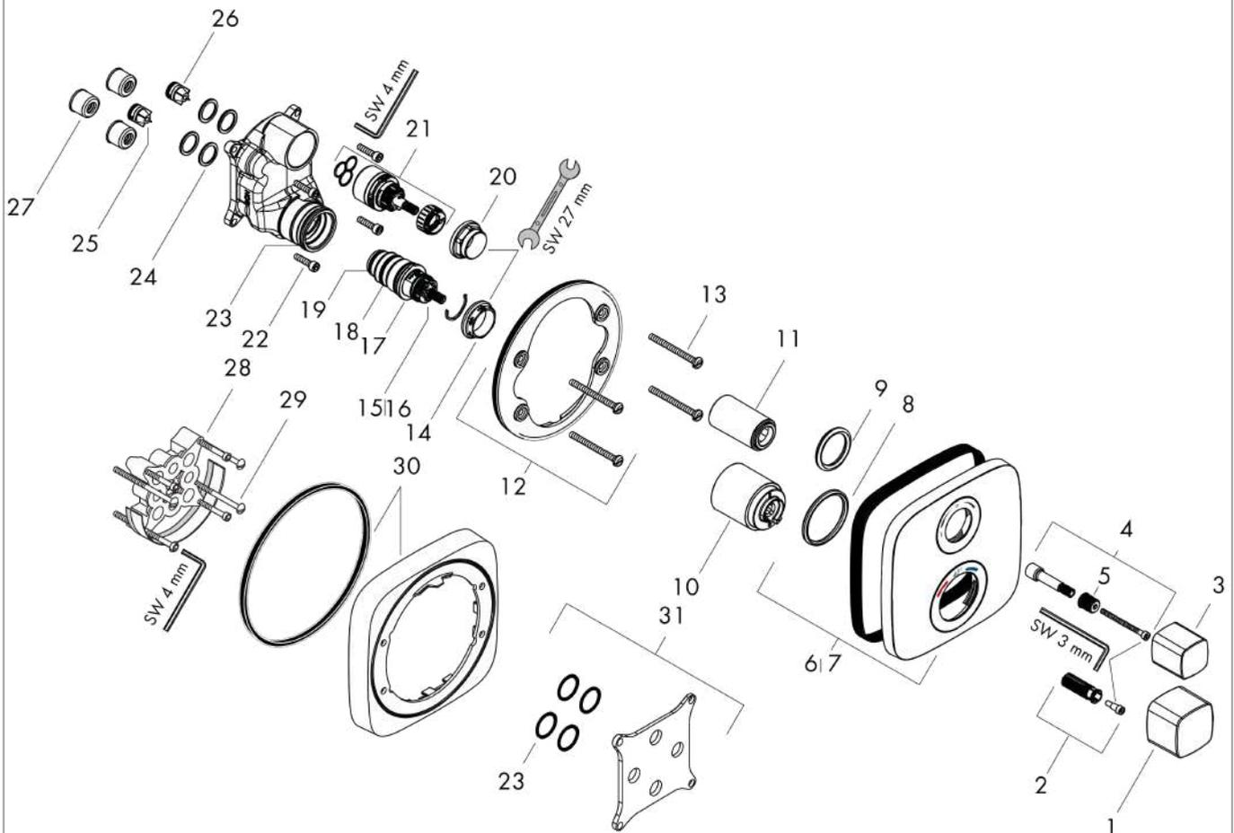
**Ecostat E****Set de finition pour mitigeur thermostatique encastré avec robinet d'arrêt et inverseur**Surfaces: **chromé** Numéro d'article: **15708000**
