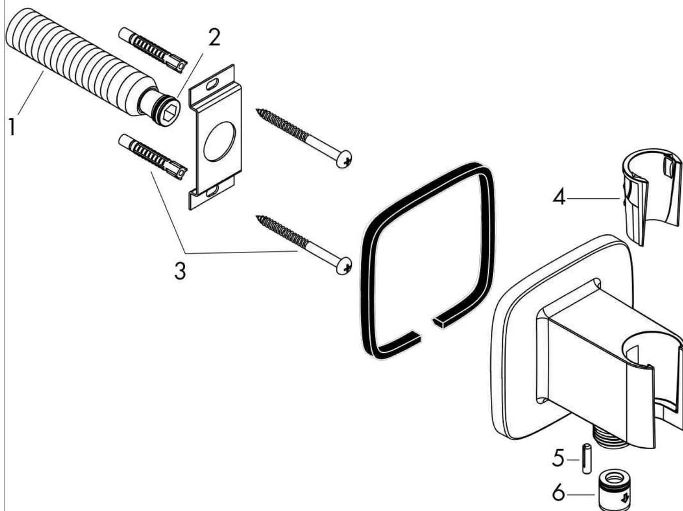
**FixFit****Coude de raccordement avec Porter E**Surfaces: **chromé** Numéro d'article: **26485000**
