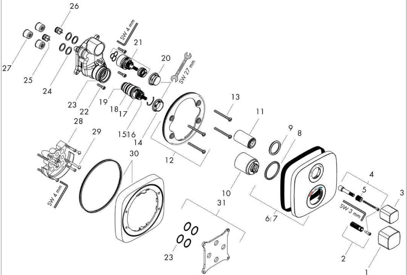
**Ecostat E****Set de finition pour mitigeur thermostatique encastré avec robinet d'arrêt et inverseur**Surfaces: **chromé** Numéro d'article: **15708000**
