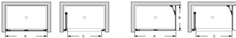
Descriptif CCTP : Pare-douche, 2 volets, version angle. E6D128. Collection : CAPSULE. DIMENSIONS : 80 x 120 x 140 cm. POIDS : 28 kg. MATÉRIAU : Verre. TYPE D'INSTALLATION : En angle. NORMES ET RÉGLEMENTATIONS : EN 14428. TYPES D'ACCESSOIRE : Pare-bain. CONSEILS D'ENTRETIEN : à nettoyer à l'eau savonneuse.
