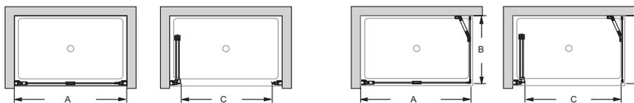
Descriptif CCTP : Pare-douche, 2 volets, version angle. E6D129. Collection : CAPSULE. DIMENSIONS : 90 x 140 x 140 cm. POIDS : 30 kg. MATÉRIAU : Verre. TYPE D'INSTALLATION : En angle. NORMES ET RÉGLEMENTATIONS : EN 14428. TYPES D'ACCESSOIRE : Pare-bain. CONSEILS D'ENTRETIEN : à nettoyer à l'eau savonneuse.
