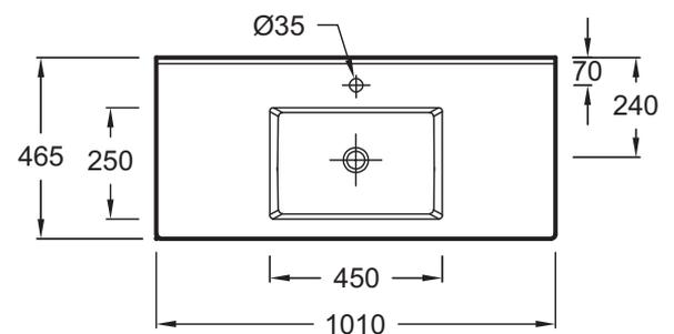
Descriptif CCTP : Pack plan-vasque/meuble 100 cm - 2 tiroirs. EBP2306. Collection : OLA UP. DIMENSIONS : 101 x 46,50 x 54 cm. POIDS : 51,8 kg. MATÉRIAU : Mélaminé. TYPE D'INSTALLATION : Suspendu. TYPE DE RANGEMENT : Tiroir. PRISE ÉLECTRIQUE : Non. DISPOSITION VASQUE : Centrée. FINITION INTÉRIEURE : Gris. FIXATION : Set de fixation à déterminer par votre installateur en fonction de votre support mural.
