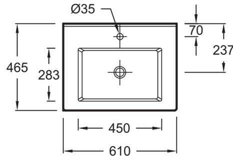
Descriptif CCTP : Pack plan-vasque/meuble 60 cm - 2 tiroirs. EBP2302. Collection : OLA UP. DIMENSIONS : 60 x 45 x 54 cm. POIDS : 36,7 kg. MATÉRIAU : Mèlaminé. TYPE D'INSTALLATION : Suspendu. TYPE DE RANGEMENT : Tiroir. DISPOSITION VASQUE : Centrée. FINITION INTÉRIEURE : Gris. FIXATION : Set de fixation à déterminer par votre installateur en fonction de votre support mural.
