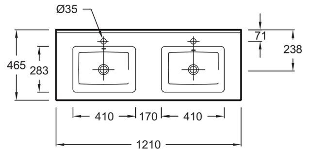
Descriptif CCTP : Pack plan-vasque/meuble 120 cm - 2 tiroirs. EBP2308. Collection : OLA UP. DIMENSIONS : 121 x 46,50 x 57 cm. POIDS : 60,4 kg. MATÉRIAU : Mélaminé. TYPE D'INSTALLATION : Suspendu. TYPE DE RANGEMENT : Tiroir. PRISE ÉLECTRIQUE : Non. DISPOSITION VASQUE : Double. FINITION INTÉRIEURE : Gris. FIXATION : Set de fixation à déterminer par votre installateur en fonction de votre support mural.
