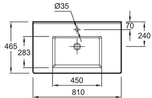
Descriptif CCTP : Pack plan-vasque/meuble 80 cm - 2 tiroirs. EBP2304. Collection : OLA UP. DIMENSIONS : 81 x 46,50 x 54 cm. POIDS : 44,4 kg. MATÉRIAU : Mélaminé. TYPE D'INSTALLATION : Suspendu. TYPE DE RANGEMENT : Tiroir. PRISE ÉLECTRIQUE : Non. DISPOSITION VASQUE : Centrée. FINITION INTÉRIEURE : Gris. FIXATION : Set de fixation à déterminer par votre installateur en fonction de votre support mural.
