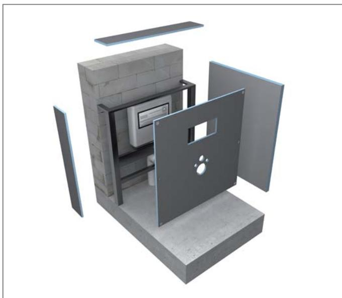
wedi I-Board (1 200 × 1 245 × 20 mm) est un élément de montage préparé et destiné à l'habillage des WC suspendus. Facilement adaptable aux besoins de chacun grâce à une largeur de 1 200 mm. Solidité et résistance extrêmes en dépit d'un poids faible (résiste jusqu'à 400 kg à partir d'un format de carreaux de 10 × 10 cm). Après installation, le carrelage peut être posé sans traitement préalable.
