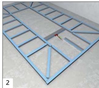
2 En respectant des distances maximales de 40 cm, coller les éléments supports sur la surface en utilisant la colle polymère wedi 610.
