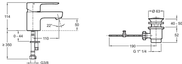
Descriptif CCTP : Mitigeur lavabo - cartouche C3. E98258. Collection : JULY. POIDS : 1,6 kg. NORMES ET RÉGLEMENTATIONS : NF : I - ECAU : E0 C3 A2 U3 (Ge5) - ACS : 10 ACCLY 113. TYPE : Mitigeur. DÉBIT (L/MN SOUS 3 BARS) : 10 l/mn. MÉCANISME : Cartouche C3 pour économies d'eau et d'énergie. ECO CONSO : Economie d'eau. VIDAGE : Avec vidage. MITIGEUR DE BAIN : MITIGEUR. TYPE D'INSTALLATION : 1 trou. GARANTIE MÉCANISME : 5 ans.
