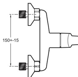
Descriptif CCTP : Mitigeur douche mural. E29870. Collection : AIME. MATÉRIAU : N/A. TYPE D'INSTALLATION : Mural. TYPE : Mitigeur. DÉBIT (L/MN SOUS 3 BARS) : 12 l/min. RACCORDS : Avec raccords et rosaces murales. GARANTIE MÉCANISME : 5 ans .
