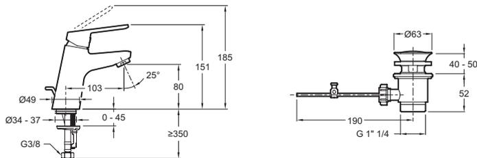
Descriptif CCTP : Mitigeur lavabo avec vidage . E29869. Collection : AIME. MATÉRIAU : N/A. TYPE D'INSTALLATION : 1 trou. TYPE : Mitigeur. DÉBIT (L/MN SOUS 3 BARS) : 5 l/min. RACCORDS : Avec flexibles d'alimentation. MÉCANISME : cartouche à disques céramique. PRODUIT INCLUS : Vidage. GARANTIE MÉCANISME : 5 ans. GARANTIE FINITION : Chrome 10 ans / Noir Mat 2 ans .
