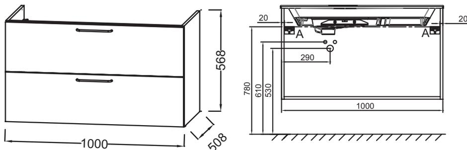
Descriptif CCTP : Meuble sous plan-vasque 100 cm, 2 tiroirs. EB2524-R5. Collection : ODÉON RIVE GAUCHE. DIMENSIONS : 100 x 50,80 x 56,80 cm. POIDS : 36,7 kg. MATÉRIAU : Laque ou mélaminé. TYPE D'INSTALLATION : Suspendu. RANGEMENT : Meuble sous plan-vasque. VERSION : Avec passe-siphon. DISPOSITION VASQUE : Gauche. POIGNÉE : Chrome. FINITION INTÉRIEURE : Gris.
