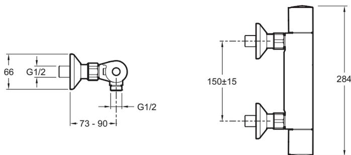
Descriptif CCTP : Mitigeur thermostatique de douche. E8456. Collection : SIMONE. TYPE : Mitigeur. DÉBIT (L/MN SOUS 3 BARS) : 12 L/min. ENTRAXE (MM) : 150 ± 15. MITIGEUR DE DOUCHE : THERMOSTATIQUE. BUTÉE DE SÉCURITÉ : 37°C. GARANTIE MÉCANISME : 5 ans. GARANTIE FINITION : 10 ans.
