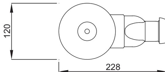
Descriptif CCTP : Bonde extra-plate. E78168. Collection : HORS COLLECTION. POIDS : 0,3 kg. DIAMÈTRE DE BONDE (CM) : 90 mm. TYPE D'ACCESSOIRE : Bonde. Débit 36 l/mn. Encombrement réduit 58 mm.
