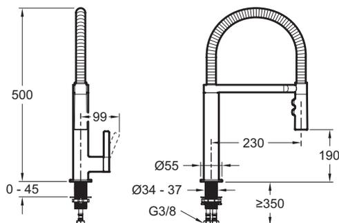
Descriptif CCTP : Mitigeur évier - douchette extractible. E23310. Collection : SPIRALE. DIMENSIONS : 12,70 x 21,50 cm. TYPE D'INSTALLATION : 1 trou. TYPE : Mitigeur. DÉBIT (L/MN SOUS 3 BARS) : 7 l/mn. HAUTEUR TOTALE DU ROBINET (MM) : 448. SAILLIE DU BEC (MM) : 230. RACCORDS : Avec flexibles d'alimentation. MÉCANISME : Cartouche à disques céramique. TYPE D'INSTALLATION : 1 trou.
