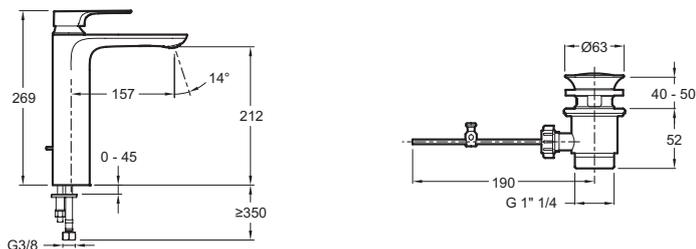
Descriptif CCTP : Mitigeur lavabo - modèle haut - avec flexibles d'alimentation tournants. E72337. Collection : ALEO+. NORMES ET RÉGLEMENTATIONS : ACS : 10 ACC LY 113. DÉBIT (L/MN SOUS 3 BARS) : 5 l/mn. HAUTEUR TOTALE DU ROBINET (MM) : 269. SAILLIE DU BEC (MM) : 157. RACCORDS : Avec flexibles d'alimentation. MÉCANISME : Cartouche à disques céramique. ECO CONSO : ECO D'EAU. VIDAGE : Sans vidage. TYPE DE ROBINETTERIE DE CUISINE : MECANIQUE. TYPE D'INSTALLATION : 1 trou. GARANTIE MÉCANISME : 5 ans.
