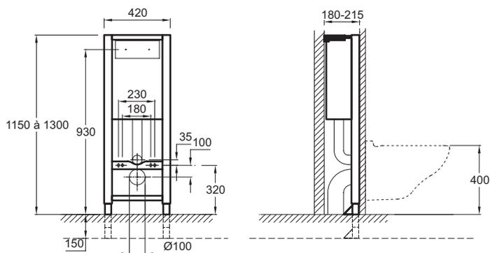
Descriptif CCTP : Bâti-support au sol avec réservoir à mécanisme 3/6 L. E4311. Collection : HORS COLLECTION. DIMENSIONS : 42 x cm. POIDS : 17 kg. TYPE D'INSTALLATION : Autoportant ou en applique sur mur ou en cloison légère ou en gaine technique. CONSOMMATION D'EAU : Standard 3/6 L. TYPE DE SUPPORT : Bâti-support auto-portant. Livré avec jeu de fixations murales. Livré avec 2 tiges filetées M12 pour fixation de la cuvette avec protection. Plaque de commande non incluse.
