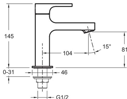
Descriptif CCTP : Robinet indépendant pour lave-mains (eau froide). E37333. Collection : STRAYT. POIDS : 1 kg. TYPE D'INSTALLATION : 1 trou. NORMES ET RÉGLEMENTATIONS : ACS : 15 ACC LY 081. DÉBIT (L/MN SOUS 3 BARS) : 5 l/mn. MÉCANISME : Tête à disques céramique. TYPE D'INSTALLATION : 1 TROU. Aérateur anti-calcaire. Sans bonde de vidage.
