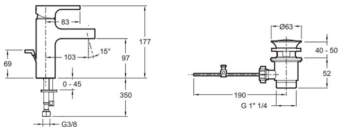
Descriptif CCTP : Mitigeur lavabo - modèle medium - avec flexibles d'alimentation. E37327. Collection : STRAYT. POIDS : 2,7 kg. TYPE D'INSTALLATION : 1 trou. DÉBIT (L/MN SOUS 3 BARS) : 5 l/mn. RACCORDS : Avec flexibles d'alimentation. MÉCANISME : Cartouche à disques céramique.. TYPE D'INSTALLATION : 1 TROU. Aérateur anti-calcaire intégré. Bague-limiteur de température.
