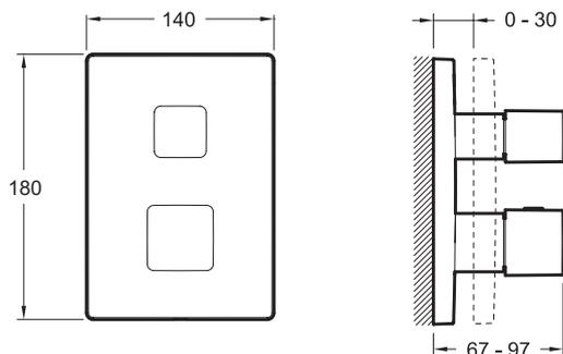
Description : Mitigeur thermostatique avec robinet d'arrêt/sélecteur 2 voies - façade Square. E75391. Collection : MODULO. Poids : 2,9 kg. Type d'installation : Encastré. Normes et réglementations : ACS : 14 ACCLY 587. Mitigeur thermostatique avec robinet d'arrêt/sélecteur 2 voies. Façade et poignées en métal. Corps à encastrer G1/2. Clapets anti-retour sur les alimentations. Débit : 26 l/mn sous 3 bars. A associer avec boîtier universel 98699D.
