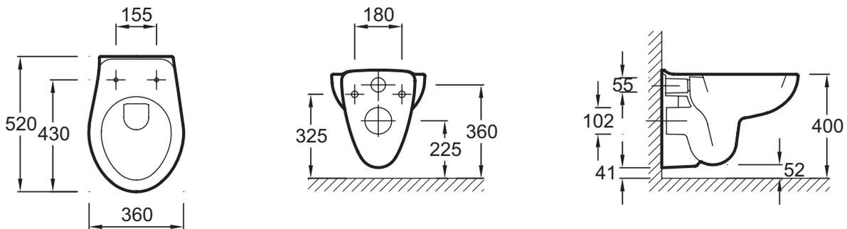
Description : Cuvette suspendue 52 x 36 cm. E4345. Collection : MIDEO. Dimensions : 52 x 36 cm. Poids : 14,5 kg. Matériau : Céramique. Type d'installation : Suspendu. Volume d'eau : 2,6/4 L et 3/6 L. Hauteur : Réglable de 38 à 50 cm. Type de bride : Ouverte (traditionnelle). Cuvette semi carénée.
