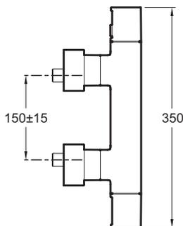
Description : Mitigeur thermostatique douche mural.. E73164. Collection : COMPOSED. Poids : 3,7 kg. Installation : Mural. Normes : ACS n° 14 ACC LY 587. Raccords : Avec raccords et rosaces murales. Mécanisme : Cartouche à cire dilatable. Entraxe : 150 +/- 15 mm. Clapets anti-retour sur les alimentations..
