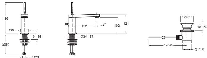
Description : Mitigeur lavabo - levier "Joystick".. E73158. Collection : COMPOSED. Poids : 2,5 kg. Installation : 1 trou. Normes : ACS : 14CCLY511. Débit : Débit limité à 5 l/mn. Hauteur totale du robinet : 193 mm. Saillie du bec : 152 mm. Raccords : Avec flexibles d'alimentation. Mécanisme : Cartouche à disques céramique. Aérateur anti-calcaire..
