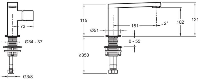
Description : Mitigeur lavabo - levier "Pure", sans vidage. E73050-ND. Collection : COMPOSED. Poids : 2,2 kg. Installation : 1 trou. Normes : ACS : 14CCLY511. Débit : 5 l/mn. Hauteur totale du robinet : 121 mm. Saillie du bec : 151 mm. Raccords : Avec flexibles d'alimentation. Mécanisme : Cartouche à disques céramique. Aérateur anti-calcaire. Sans tirette, sans bonde de vidage.
