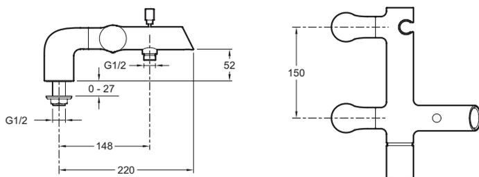
Description : Mitigeur bain-douche sur gorge. E8964. Collection : TOOBI. Poids : 3,3 kg. Installation : Sur gorge. Débit : 30 l/mn sous 3 bars (13 l/mn sous 3 bars l'eau filtrée). Raccords : Avec raccords colonnettes. Mécanisme : Cartouche à disque en céramique de 35 mm. Inverseur automatique.
