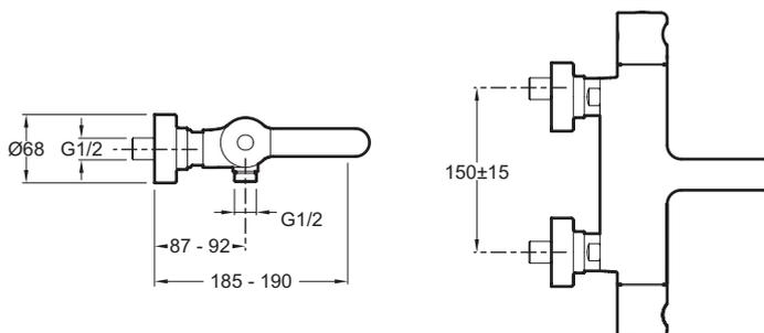
Description : Mitigeur thermostatique bain-douche mural. E10870. Collection : SINGULIER. Poids : 4 kg. Installation : Mural. Normes : NF : II/A - ECAU : E3/1 C1 A1 U3. Débit : 20 l/mn sous 3 bars. Raccords : Avec raccords et rosaces murales. Mécanisme : Cartouche thermostatique à cire dilatable avec limiteur de température et de débit. Entraxe : 150 ± 15 mm. Economiseur d'eau.
