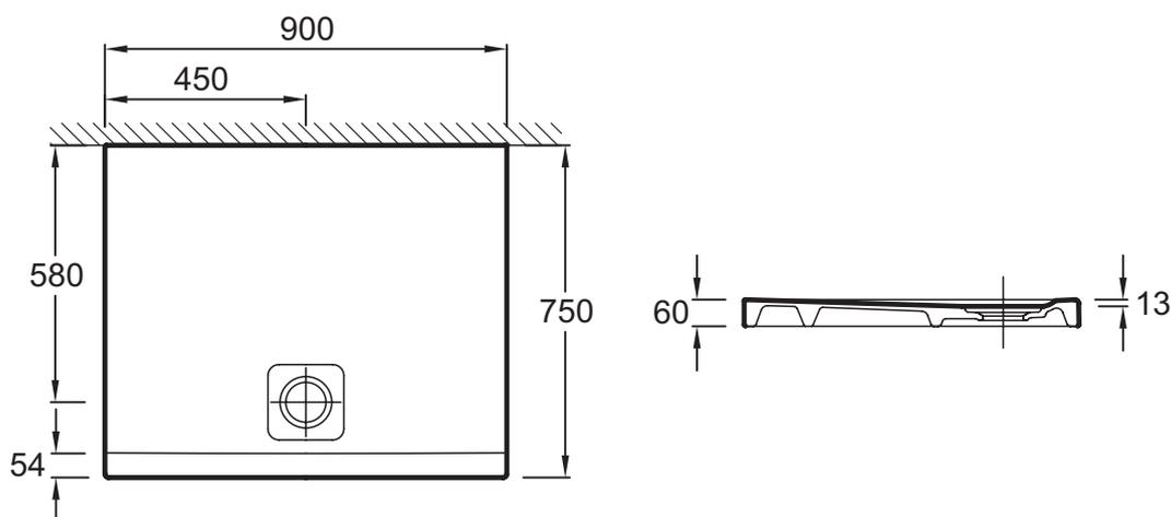
Description : Receveur à poser ou à encastrer rectangulaire. N108K. Collection : ODÉON UP. Dimensions : 90 x 75 x 6 cm. Poids : 31 kg. Matériau : Céramique. Installation : A poser/A encastrer. Forme : Rectangulaire. Diamètre de bonde : 90. En céramique : stabilité du grès facilitant la pose et l'étanchéité des joints.
