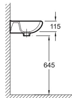
Description : Lave-mains. E4338. Collection : MIDEO. Dimensions : L 45 x P 35 cm. Poids : 8,2 kg. Matériau : Céramique. Installation : Autoportant. Percement robinetterie : Percé 1 trou de robinetterie. Fixations : Par goujon. Large plage de pose.
