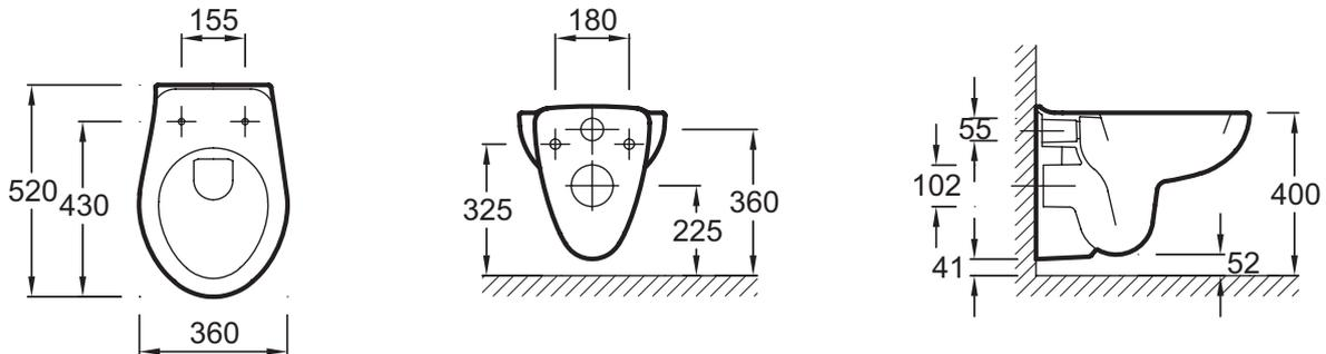
Description : Cuvette suspendue. E4345. Collection : MIDEO. Dimensions : 52 x 36 cm. Poids : 14,5 kg. Matériau : Céramique. Installation : Suspendu. Consommation d'eau : 2,6/4 L ou 3/6 L. Hauteur confort : Hauteur réglable de 38 cm à 50 cm. Type de bride : Ouverte. Fourni avec fixations : Non. Cuvette semi carénée, siphon lisse (hygiénique et entretien facilité).
