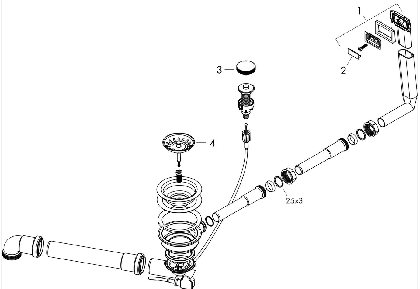
**D14-11 Garniture de vidage automatique pour simple cuve**Finition: **Acier inoxydable** Numéro d'article: **43931800**
